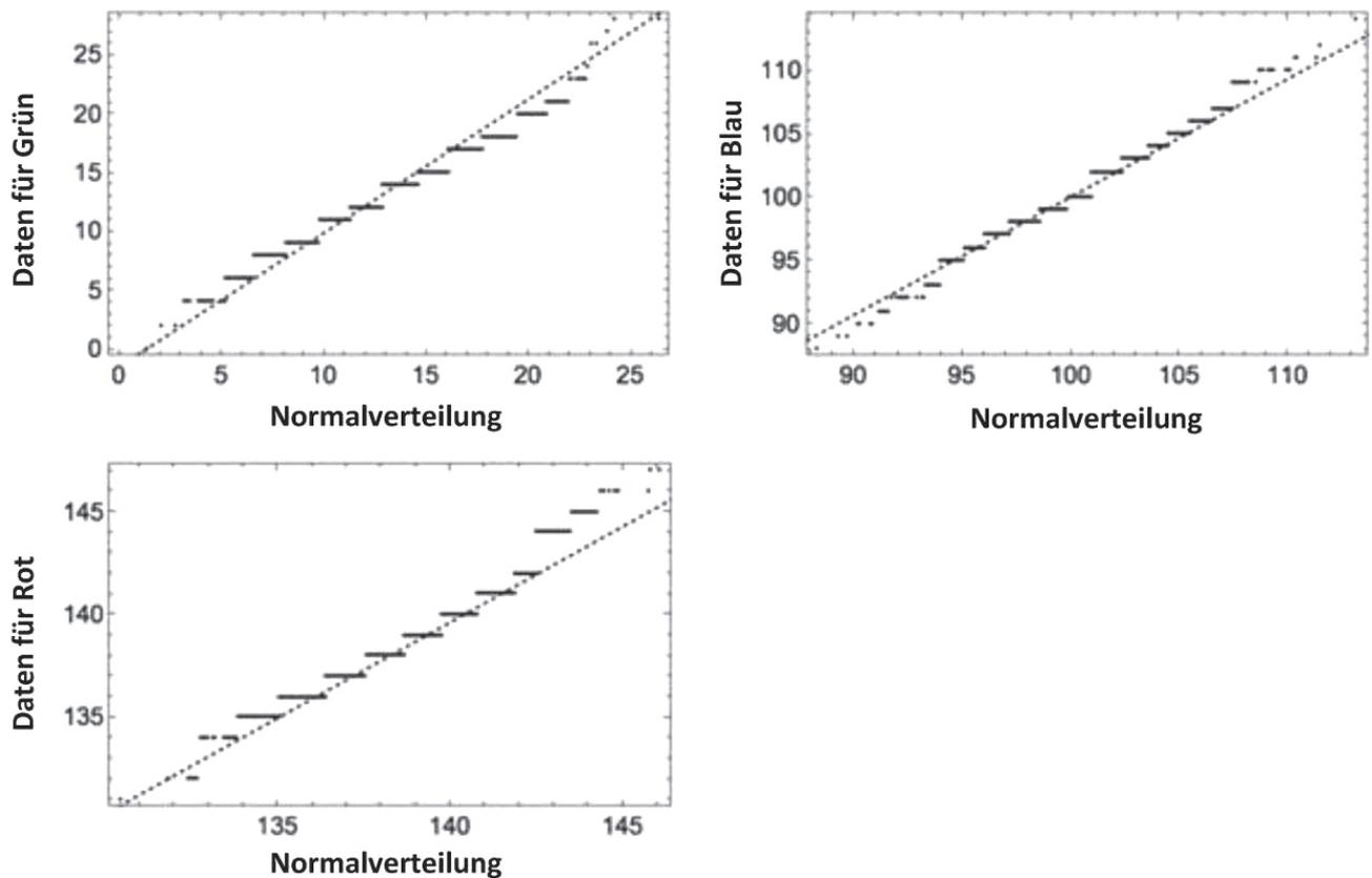
Abb. 4: Quantil-Quantil-Plots für jeden Farbkanal. Die gestrichelte Linie ist die Ursprungsgerade mit Steigung 1.
